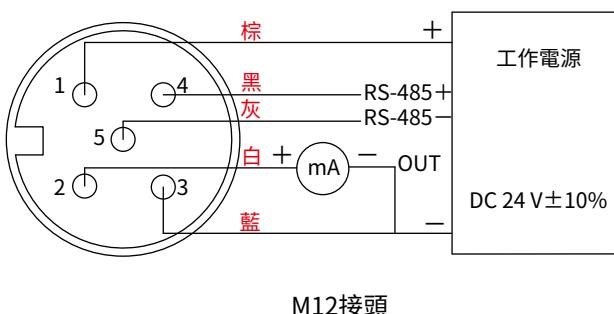
\*請確認產品與連接RS-485之儀器共地，避免接地電壓差造成損害。
