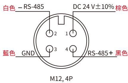
\*請確認產品與連接RS-485之儀器共地，避免接地電壓差造成損害。
