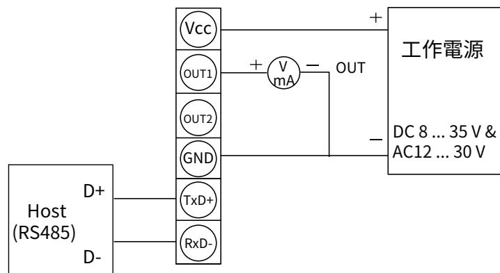
\*請確認產品與連接RS-485之儀器共地，避免接地電壓差造成損害。
