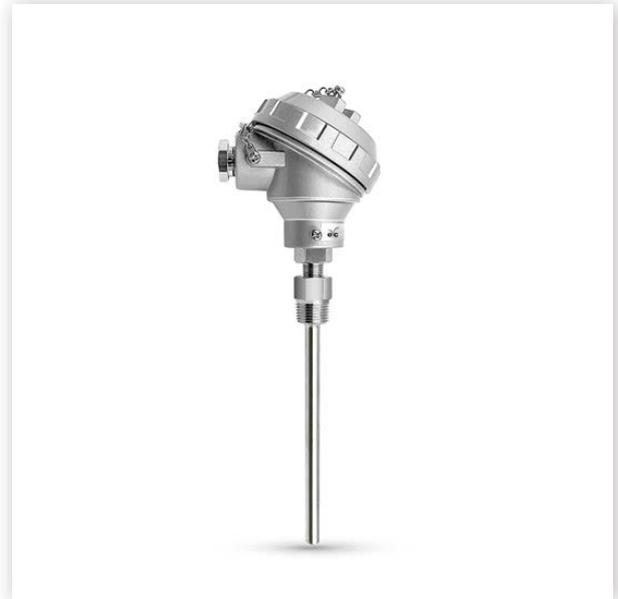
RTD鉑電阻：可用純金屬線的電阻來測量溫度，而電阻將會隨溫度之增加而以一固定的比率增加。運用此溫度係數之特性，即可由電阻之變化而得知溫度，此為電阻式溫度計。電阻式溫度計之電阻體材料有白金、鎳、銅等等，而白金因其安定性及再現性優於其他金屬材料，因此最常作為此用途，它是由一純白金線纏繞於細長的雲母片上，並被覆蓋上保護用的雲母片，再加上一個不銹鋼或其他材料的薄片而所組成的。有一些元件是由電阻線纏繞在玻璃或雲母的線心結構上，而後再將此組合密封於一硬質的玻璃或陶瓷管中，這個元件與補償導線互相接觸(二條或三條)而被放入保護管中，且與端子盒及配件相互連接。
